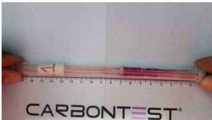
Foto 11 - Misura profondità di carbonatazione su provetta polvere di perforazione
